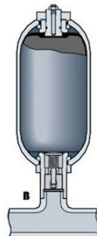
A- 将柔性分离器气囊安装到压力容器（蓄能器外壳）中。
