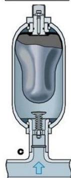
C- 当回路压力P 1 高于气体预充压力P 0 时，液体阀打开，气囊被压缩，气体体积减少至V 1 。
